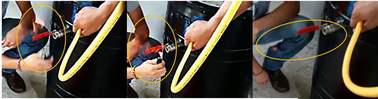
Figura 4. Prueba de la flama realizada directamente de la llave de paso del biodigestor.
