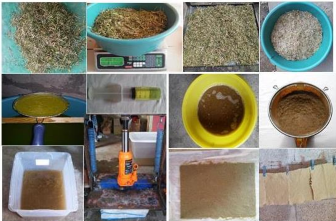
Figura 2 Ilustraciones del proceso de la obtención de cartón ecológico a partir de zacate estrella.
