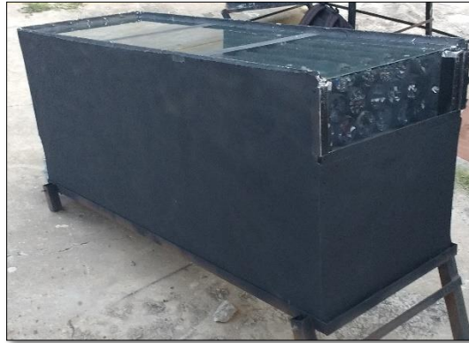
Figura 1. Secador solar. Fuente: Propia.
