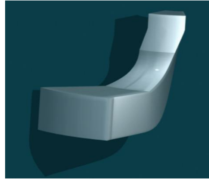
Figura 4.- Renderización de alabe y volumen de control.
