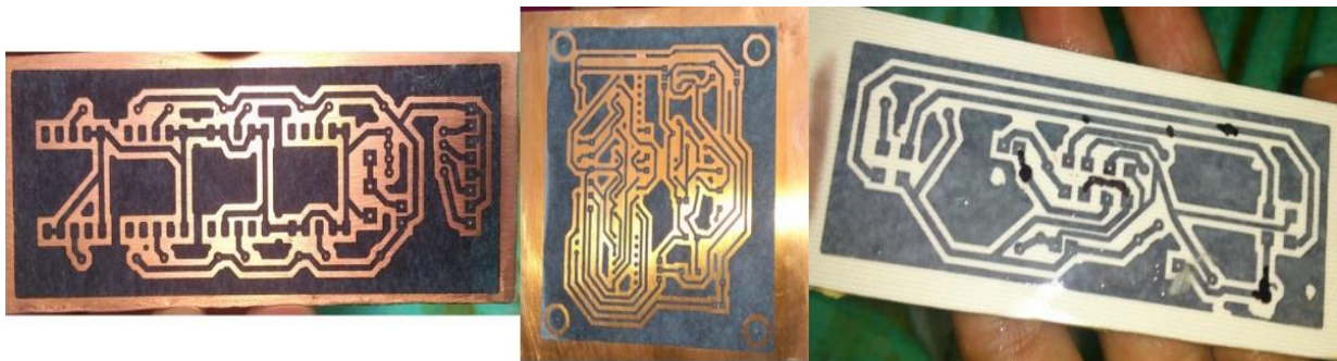
Figura 4. Diseño PBC de la placa de control, potencia y sensores
