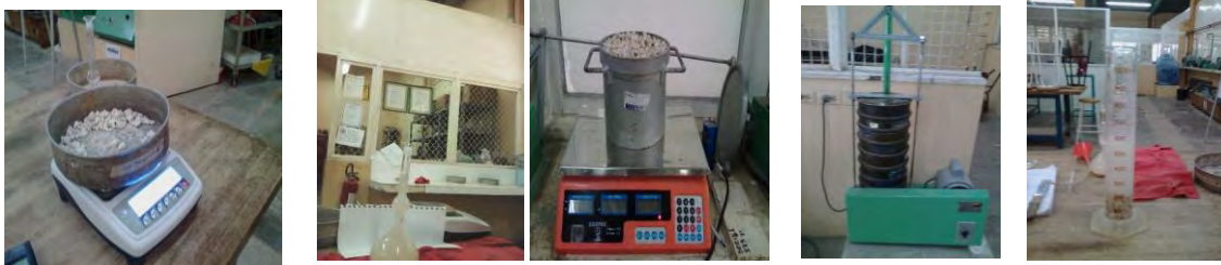
Figura 5 Pruebas realizadas a los agregados pétreos para el diseño de mezclas
