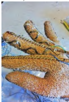
Figura 2. Interruptores de contacto colocados en guante.
