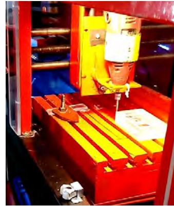
Figura 4. El eje X se mueve a la mesa de trabajo.
