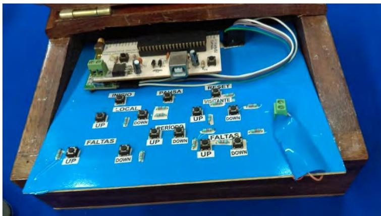
Figura 2. Consola de control inalámbrico del tablero digital.
