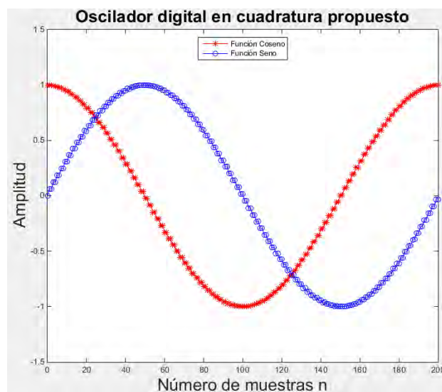
Figura 2. Oscilación generada por el oscilador digital en cuadratura propuesto.
