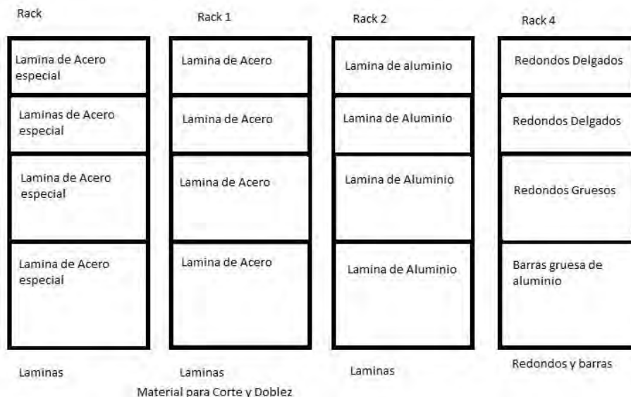
Figura 5. Distribución de materiales de los Racks
