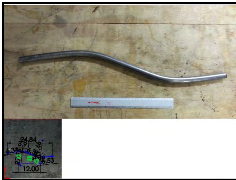
Figura 4. Croquizado acotado y autoajustado.
