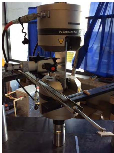
Figura 4. Ensayo de crecimiento de grieta por fatiga
