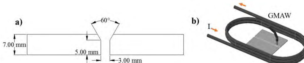
Figura 1. a) Geometría y dimensiones de la junta, b) arreglo experimental para la aplicación de la IEM.
