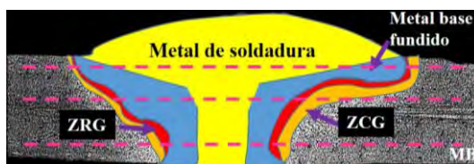
Figura 3. Perfil transversal de la soldadura con 0 mT indicando las áreas medidas y los barridos de microdureza.
