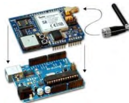
Figura 1. Tarjeta controladora Arduino (abajo) y tarjeta modem GSM Shield con antena (arriba).
