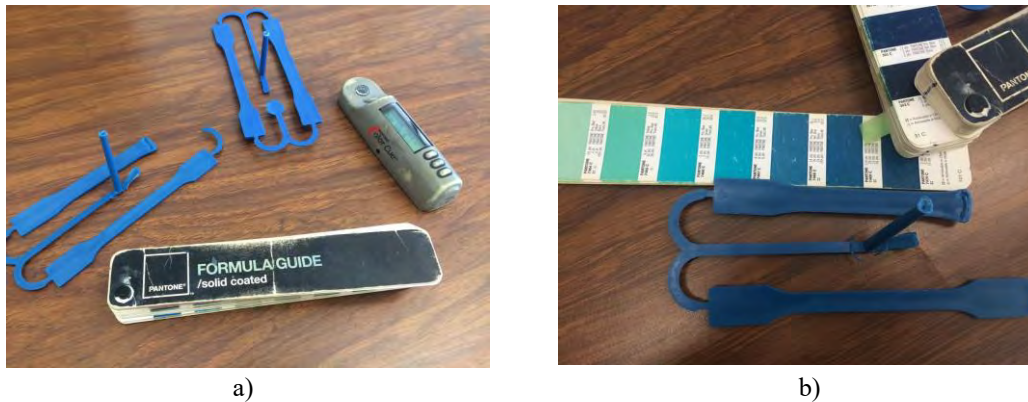
Figura 2. a) Se muestran las probetas obtenidas en la inyectora con distinto color, el colorímetro marca Pantone y la guía de colores Pantone. b) Comparación del color de la pieza con su código correspondiente en la guía.
