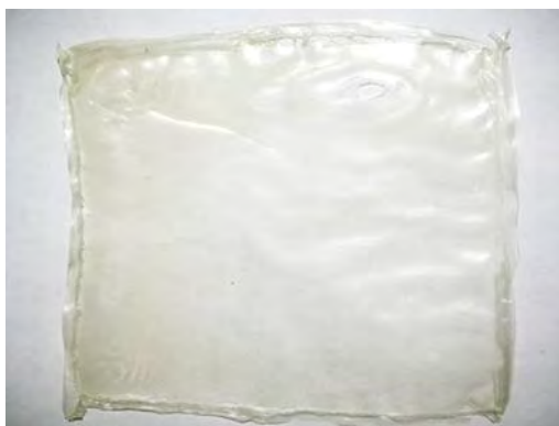
Figura 3. Película de almidón con 6.25% de WPI.
