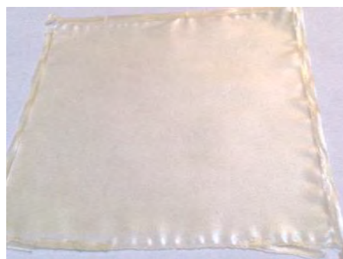
Figura 4. Película de almidón con 12.5% de WPI.
