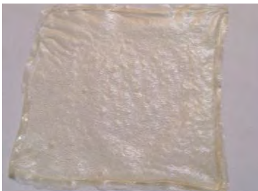
Figura 1. Película de almidón con 6.25% de LS.
