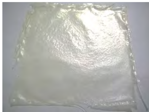
Figura 2. Película de almidón con 25% de LS.
