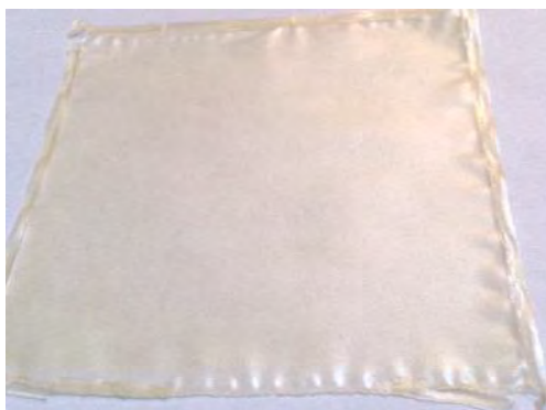
Figura 5. Película de almidón con 37.5% de glicerol.
