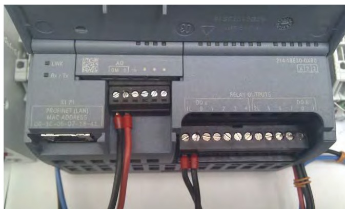
Figura 4: Conexión de los bornes del PLC
