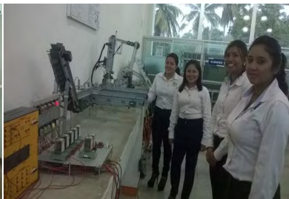
Figura 4 Sistema de entrenamiento de PLC mediante bandas transportadoras.
