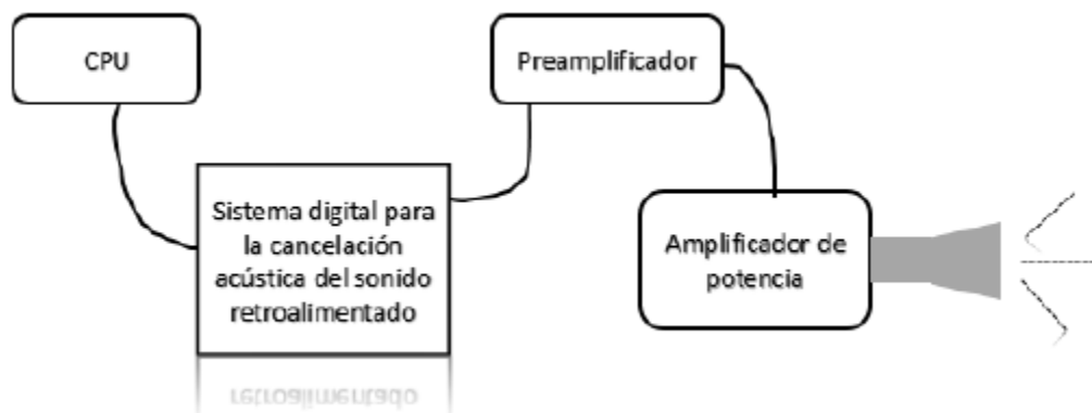
Figura 4. Diagrama a bloques de la conexión a un sistema de audio real.
