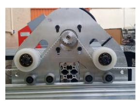
Figura 12.- Ensamble de placas con ruedas en el perfil V-Slot
