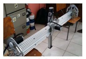
Figura 8a.- Ensamble eje Y
