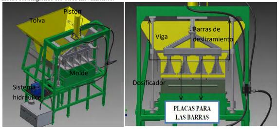
Figura 1. Ensamble de la Máquina para elaborar BTC
