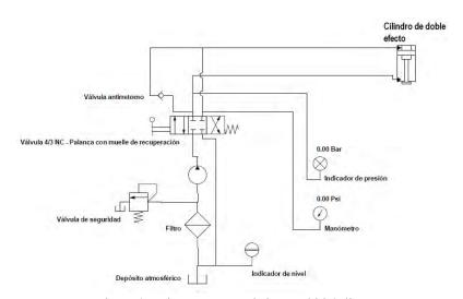
Figura 2. Diagrama para el sistema hidráulico
