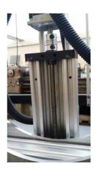
Figura 15 y 16.- Aplicación de transmisión de banda y tornillo sin fin
