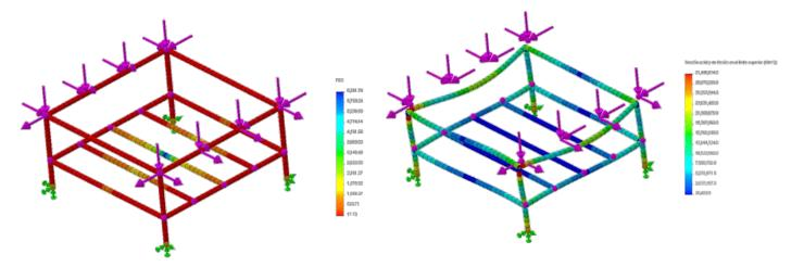
Figura 4a.- Factor de seguridad mostrada en la mesa
