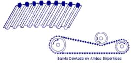
Figura 13.- Sistema de transmisión de banda
