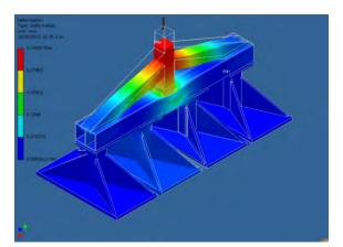
Figura 4. Deformación en el molde y la viga.
