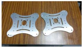
Figura 7.- placas fresadas de aluminio
