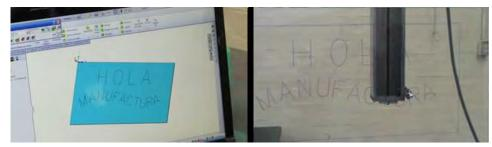
Figura 8. Comparativo de simulación CAD-CAM (izquierda) y pizarra CNC con pantalla de policarbonato (derecha).
