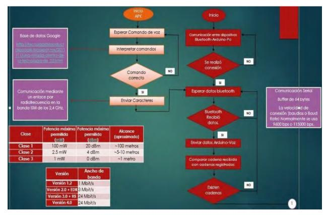
Figura 3. Diagrama de flujo de la interfaz de comunicación.
