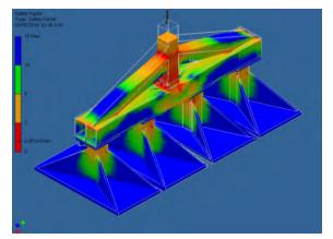
Figura 5. Factor de seguridad en el molde y la viga.
