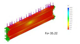
Figura 8b.- Análisis de Factor de Seguridad
