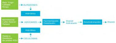
Figura 1. Esquema general de fabricación de bioetanol.
