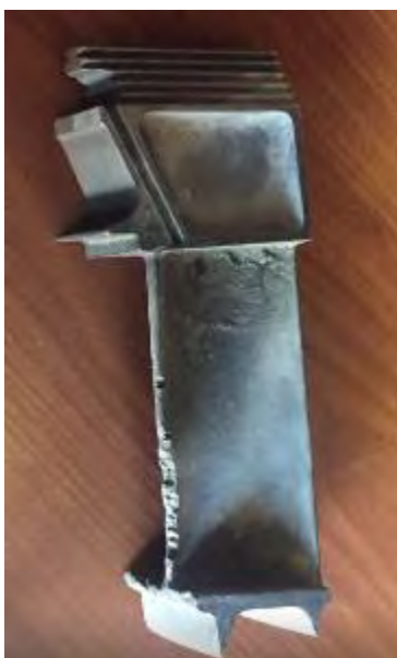
Figura 1. Alabe de Turbina metal base Inconel 739.
