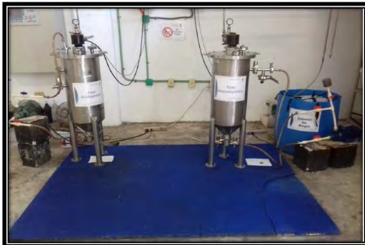
Fig. 1 Sistema de digestión anaerobia en fases
