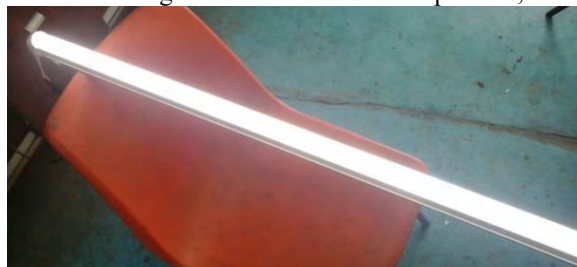
13. Lámpara tubular de leds comercial con base, funciona con a.c.
