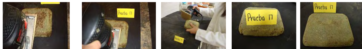
Fig. 4 Secuencia de proceso acabado (lijado) PRUEBA 17 Fotografías: Laura Lizama
