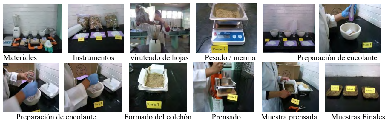
Fig.2 Secuencia de proceso de aglomerado con Cemento Blanco PRUEBA 5 Fotografías: Laura Lizama
