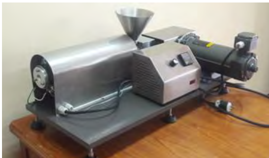
Ilustración 18 Extrusora de monofilamentos de doble husillo diseñada y desarrollada en CRODE.
