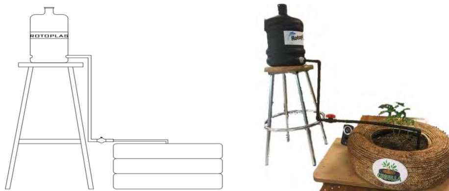
Figura 1. Prototipo de cultivo casero con un sistema de riego por goteo por gravedad.
