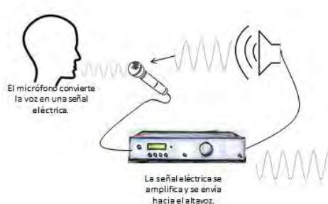
Figura 1: Esquema de la retroalimentación acústica en un sistema de audio
