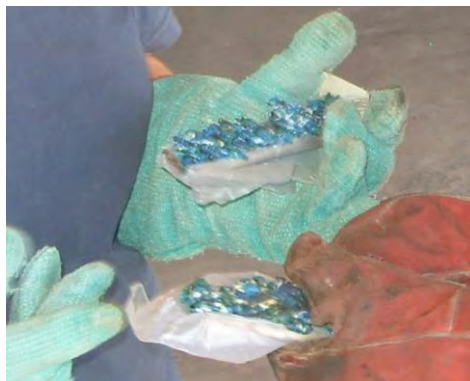
Figura 1. Manipulación de HDPE fundido para llenado del molde.
