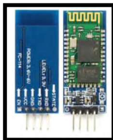
Figura 2. Módulo bluetooth HC-05
