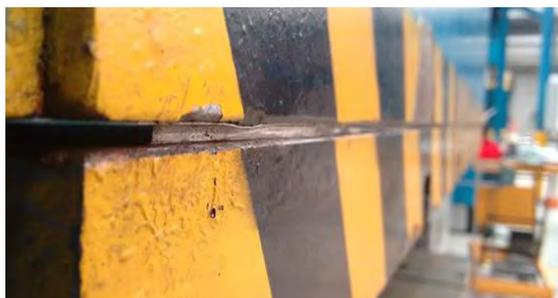
Figura 8 Calza entre platina superior y placa de sujeción de punzón.
