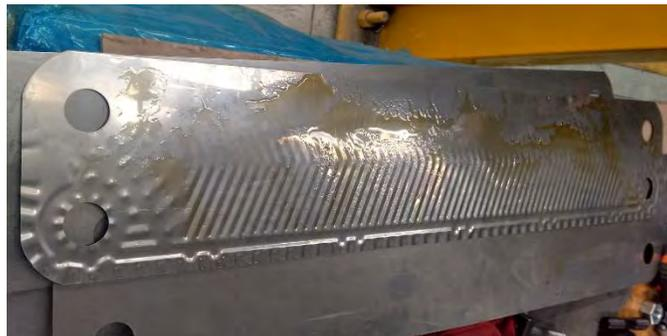
Figura 5 Placa con conformado defectuoso
