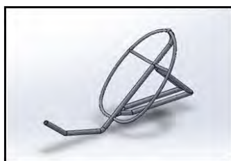
Fig.4. Modelado en CAD del chasis propuesto.
