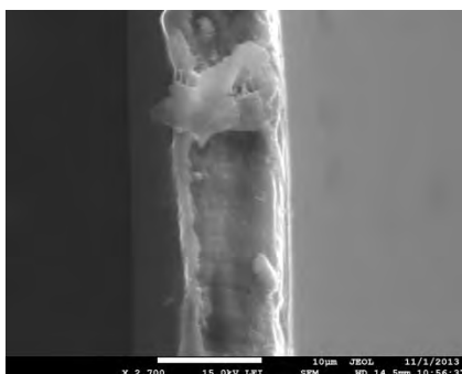
Figura 3. Determinación del espesor de la membrana por MEB. Espesor de 12 μm.
