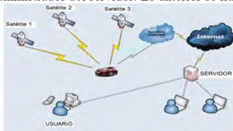
Figura 1. Composición de un sistema de rastreo satelital.
