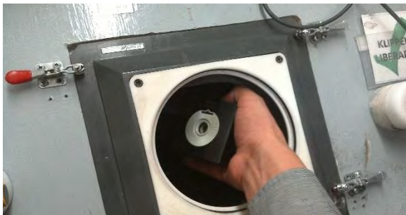
10.-Se coloca el calibrador y una vez dentro se enciende
