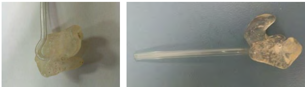
Figura 5. Izquierda: Molde proceso anterior, Derecha: Molde proceso mejorado.
