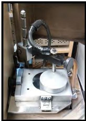
Figura 1.- Probeta en la cámara de combustión
