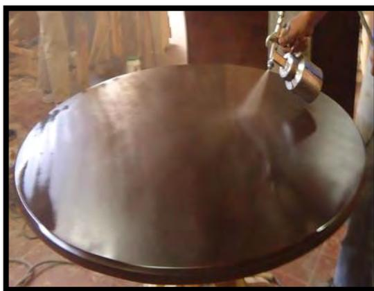
**Fig. 1** Aplicación de pintura al mueble de madera
