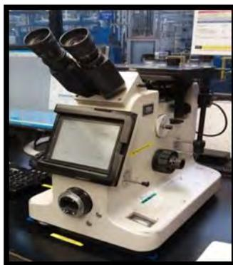
Figura 4. – Microscopio metalográfico invertido.
