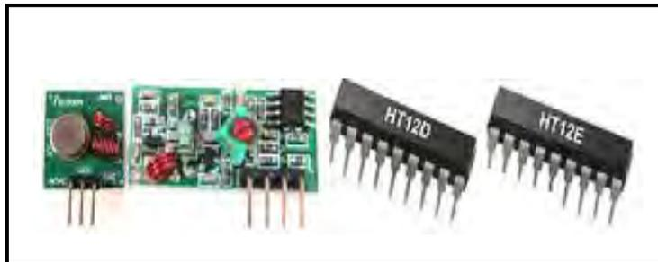
**Fig. 3** Modulo RF 433Mhz y decodificadores.
