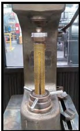
Figura 6.- Durómetro.
