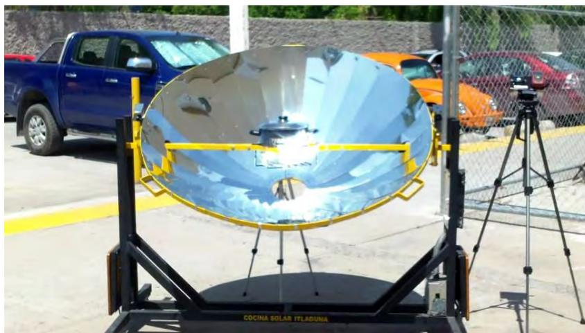
Figura 1 Concentrador Solar de Disco Parabólico ITLaguna
