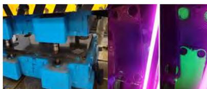
**Fig. 5. Conformado y Revelado de fisuras en laminas.**
