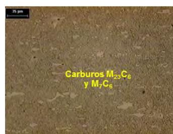
**Tabla 6.** Micrografía de la muestra obtenida después de aplicar el tercer revenido, la cual se observa la
