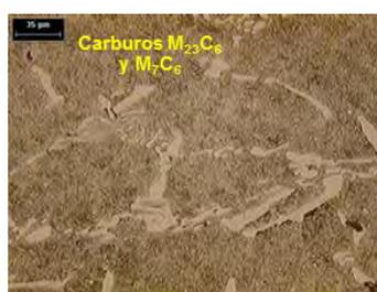
**Tabla 5.** Micrografía de la muestra obtenida después de aplicar el segundo revenido, en la que se visualiza
