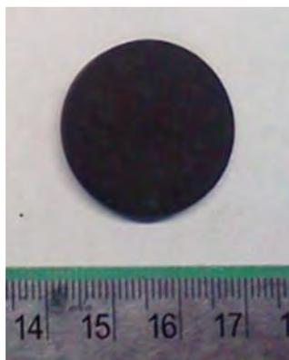
**Figura 2.-** Muestra de acero grado herramienta D2 tratadas térmicamente y enfiada en aceite.
