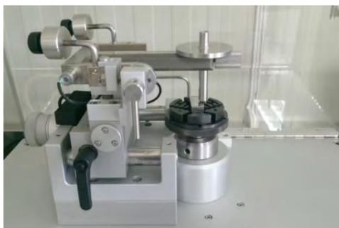
**Figura 3.** Tribómetro utilizado para el ensayo de desgaste
