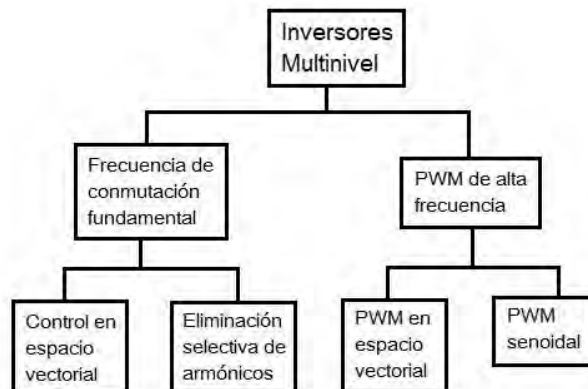
Figura 5. Clasificación de métodos de modulación multinivel.
