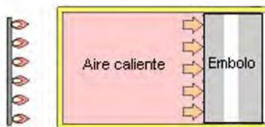
Figura 1 calentamiento del aire dentro de un cilindro
