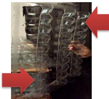
El Protector Bucal se realiza con unas láminas de un PET especial las cuales se introducen a una maquina termo formadora la cual funciona a base de resistencias para generar calor y así pueda hacer que la lámina sea moldeable para que luego unos pistones la presionen contra un molde al cual también se le aplica vacío para generar la forma deseada.
