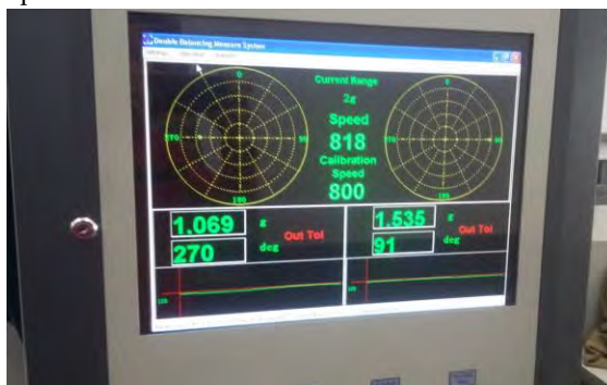
Figura 7. Cantidad de desbalance inicial del rotor.
