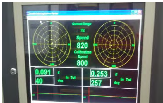
Figura 8. Cantidad de desbalance final del rotor.
