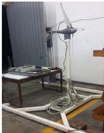
Figura 9. Montaje del aerogenerador en el túnel de viento.
