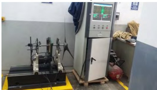
Figura 6. Vista del equipo de balanceo dinámico.
