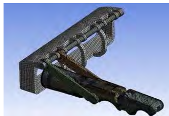
Figura 8. Malla utilizada para el cálculo de los esfuerzos y deformaciones del prototipo.
