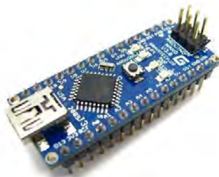
Figura 6. Tarjeta de adquisición de datos (Arduino Nano).
