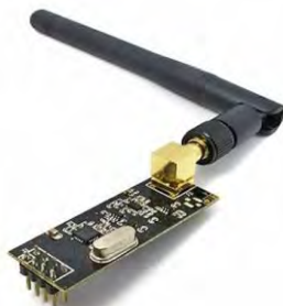
Figura 7. Antena de comunicación NRF24L01.
