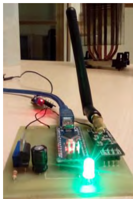
Figura 8. Transmisor con led indicador para envío de datos.
