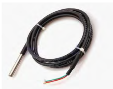
Figura 3. Sensor DS18B20 aislado para medición de temperatura.
