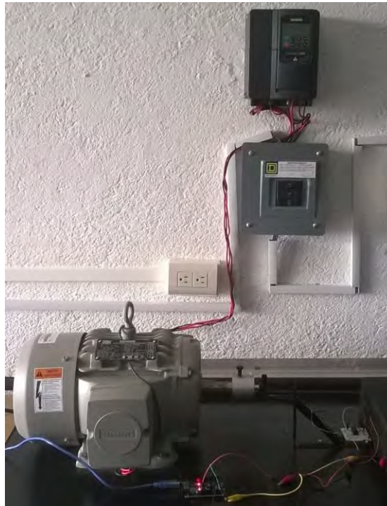
Figura 6. Sistema para la implementación del control en lazo cerrado.
