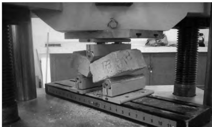
Figura 2. Ensayo de flexión en ladrillos
