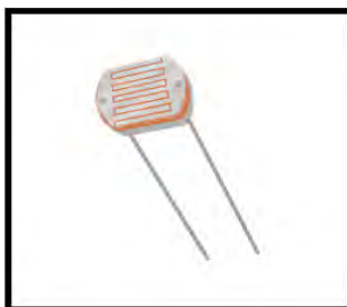
Figura 5. Fotorresistencia empleado como sensor de luminosidad.
