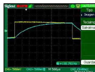
Fig 8. Comparación experimental de la respuesta transitoria cuando R = 10K\Omega .
