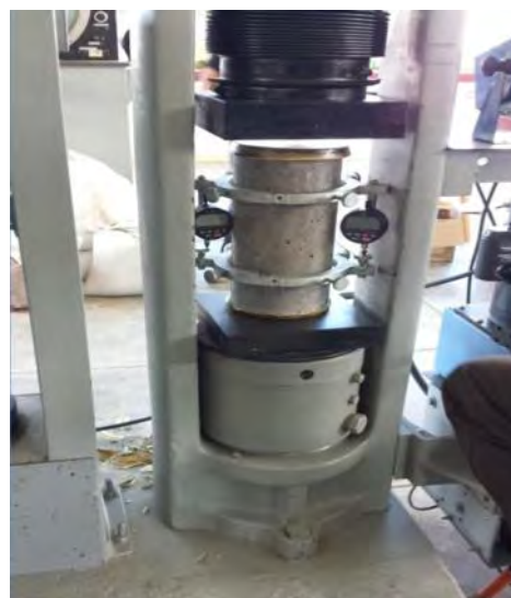
Figura 4. Prueba de módulo de elasticidad con la máquina universal.
