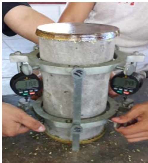
Figura 3. Montaje del equipo de medición.
