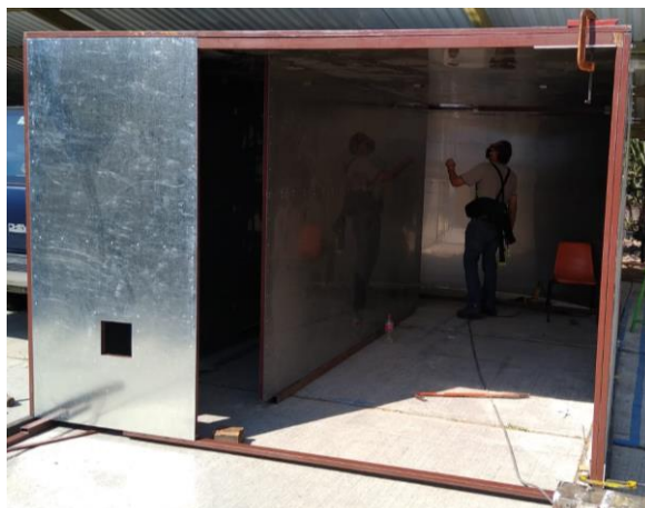
Figura 6. Ensamblado preliminar del deshidratador para las pruebas iniciales
