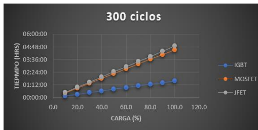
Figura 15 - Comparación de rendimiento basado en 300 y 600 ciclos de carga (Porcentaje de carga) en cada nivel de carga versus tiempo (hr) en modo real, en los tipos de transistores.
