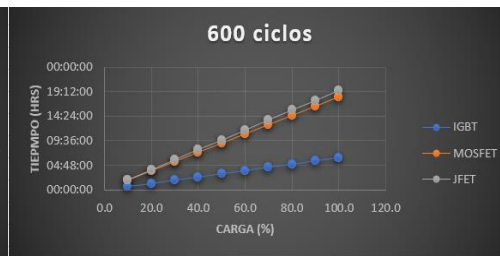
Figura 15 - Comparación de rendimiento basado en 300 y 600 ciclos de carga (Porcentaje de carga) en cada nivel de carga versus tiempo (hr) en modo real, en los tipos de transistores.
