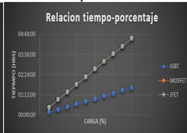
Figura 13 - Comparación entre el porcentaje de carga deseado y el tiempo requerido, a 220 V de carga, modo ideal.
