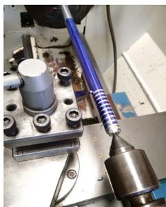
Figura.17 Montaje de pieza y Roscado
