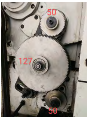
Figura. 10 Cambio de engranes para la configuración de paso de diente.
