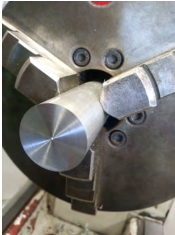
Figura. 12 Careado de la pieza
