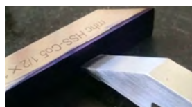
Figura.7 Marcando punto medio del buril
