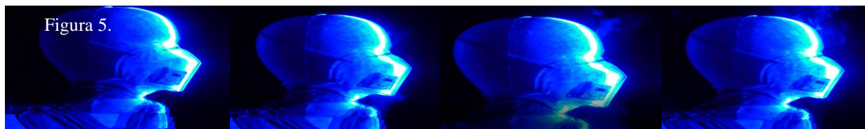
Figura 5. Atomización de aerosoles respiratorios con mascarilla de alta eficiencia N95 con válvula.
