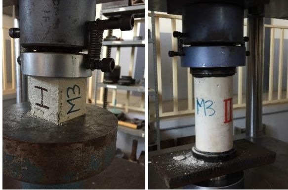
Figura 4. Cubos y cilindros sometidos a compresión
