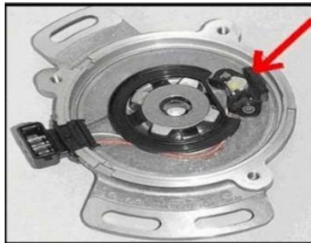
Figura 1. Sensor de Efecto Hall
