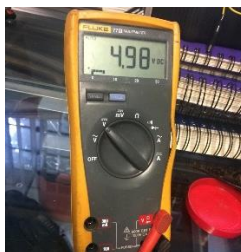
Figura 6. Voltaje de salida de la Fuente de poder.
