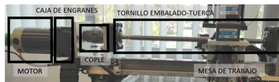
Figura 2. Composición de un eje del robot.
