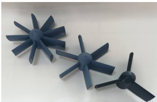
Figura 1. Vista frontal de las tres microturbinas definidas, construidas y probadas.
