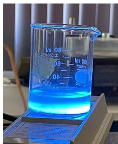
Imagen 4. Fotoluminiscencia de Óxido de Grafeno Fluorado con luz Uv de 360 nm
