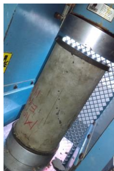
Imagen 1 Prueba de compresión según la norma ASTM C39.
