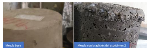
Imagen 8 Cilindros de ensaye: Mezcla base y mezcla con expansión en la corona
