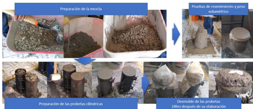
Imagen 7 Proceso de elaboración de probetas cilíndricas
