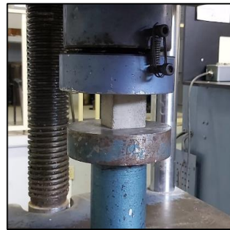
Figura 4. Cubos de mortero sometidos a prueba de resistencia a compresión
