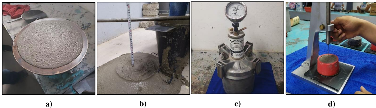
Figura 2. Prueba de fluidez, revenimiento, contenido de aire y tiempo de fraguado
