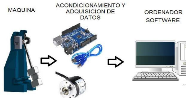
Figura 3. Sistema de instrumentación
