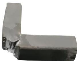
Figura 10. Estado de la probeta después del impacto.
