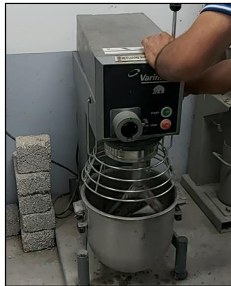
Figura 1. Elaboración del mortero
