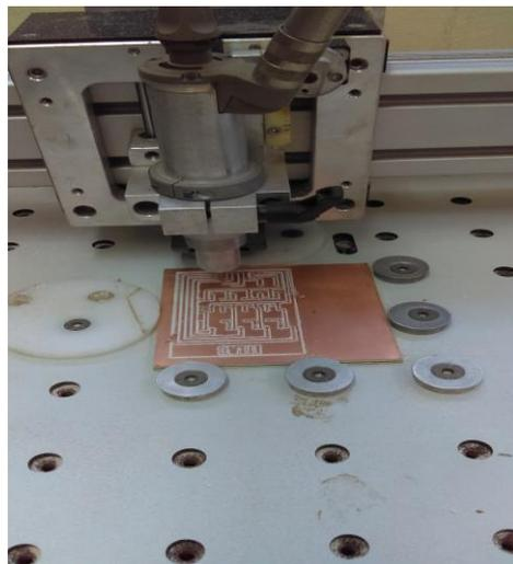
*Figura 7. Máquina para la elaboración de los circuitos impresos.*
