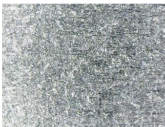
Figura 3: Imágenes 500x de los electrodos rayado con una lijadora BLACK + DECKER modelo SS200 con papel de lija P50, (microscopio marca Digital Microscope Magnification)
