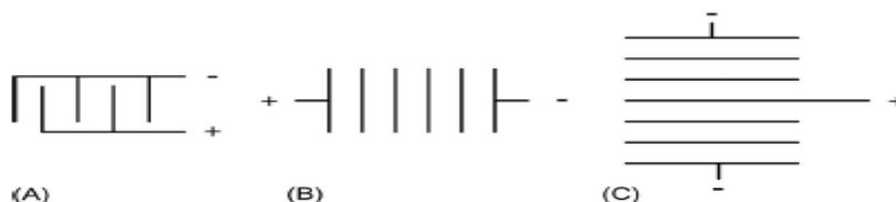
Figura 2. Configuración de celdas electrolíticas; (A). - mono polar, (B). -bipolar (C). -bipolar con ánodo central
