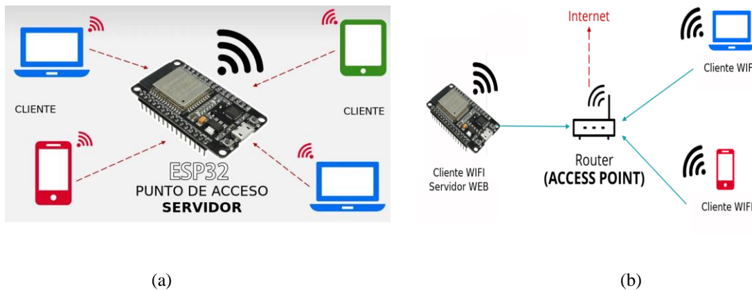
Figura 2. Arquitecturas de conexión inalámbrica del ESP32. (a) Punto de acceso; (b) Cliente en una red inalámbrica.
