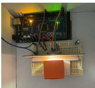
Figura 7. Caja conteniendo los elementos: Arduino Mega, Sensor color y cubo de color.
