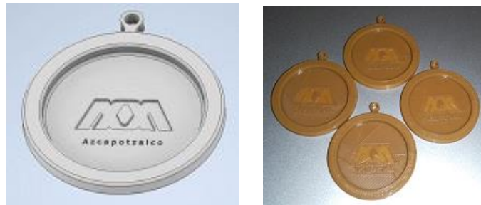
Figura 2. Modelo en CAD y pieza impresa en PLA
