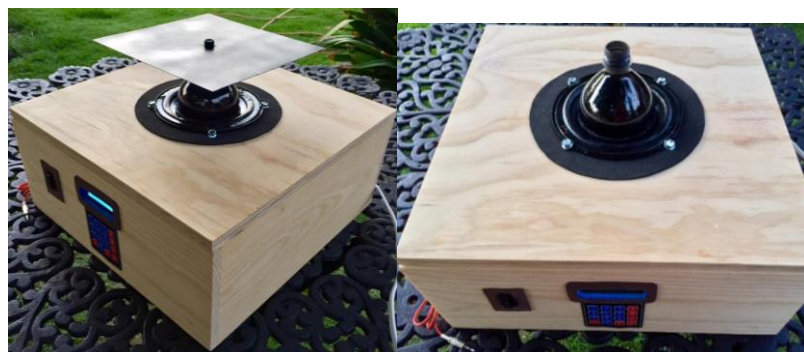
Figura 6 Vista general del sistema generador de vibraciones.
